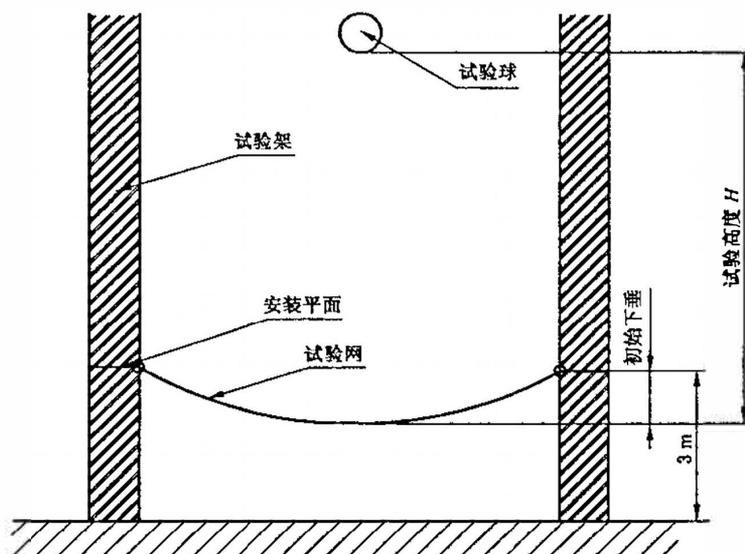
图 A.1 平(立)网的耐冲击性能测试
