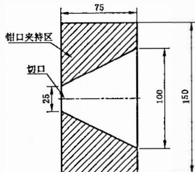
图 1 梯形法撕裂强力试样夹持示意图
